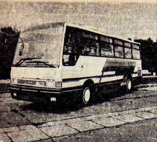
«Икарус-31Л-545» — дизельный автобус 9-метрового класса, рассчитанный на 32 пассажира.
