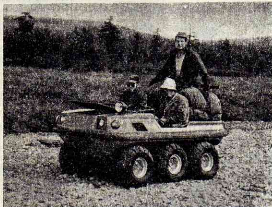
Шестиколесный вездеход на арочных шинах обладает высокой проходимостью и не повреждает верхний слой грунта в тундре.
